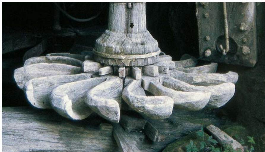
Il ritrecine ( rodesne ) con infisse le pale a forma di cucchiaio che, sotto la spinta dell'acqua, ruota mettendo in movimento la mola superiore.
