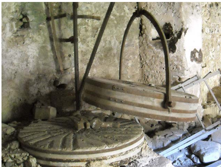
La mola superiore sollevata con "al ciev dla mesna" per procedere al rifacimento della zigrinatura delle superfici che si sfiorano durante la macinazione.
