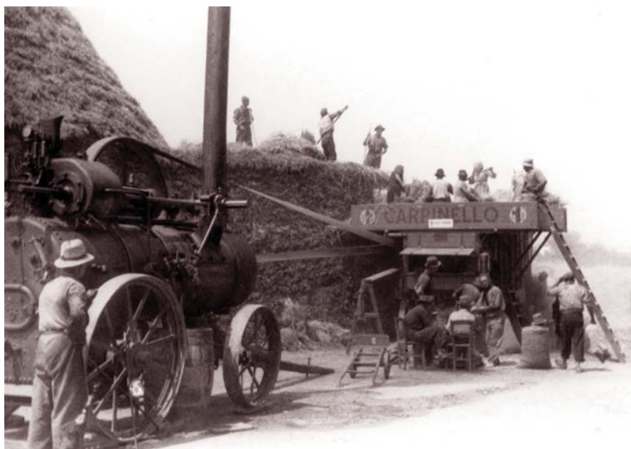
Una veduta d'insieme della complessa operazione della trebbiatura, anni '30: la caldaia a vapore in primo piano, la trebbiatrice, il barco con i diversi gruppi di lavoro. (da "Una volta in campagna" di R.G., Aquacalda Editore, Forlì, 2009)
